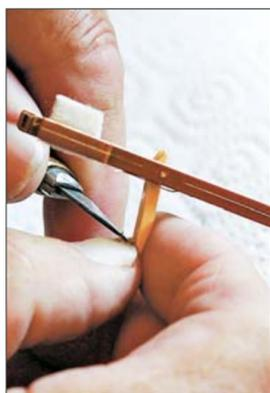
**Feinarbeit:** Jeder einzelne Kiel wird von Hand zugeschnitten. Die Kiele reißen die Saiten an und sorgen damit für den Ton.
