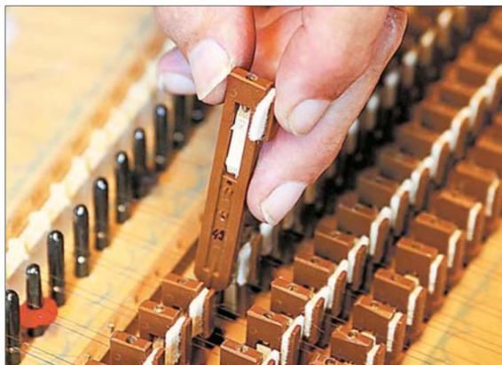
**Springer** werden auf dem Tastenende platziert. Wird die Taste gedrückt, hebt sich der Springer mit dem Kiel, der die Saite anzupft.
