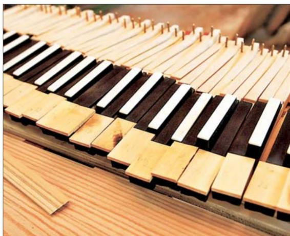
**Die Tastenbeläge** – auf diesem Bild sind sie aus Buchsbaum – müssen einzeln aufgeleimt werden. Beliebte sind auch Beläge aus Ebenholz.
